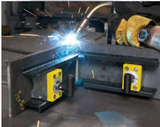
Magnetický vnitřní systém je zkratován = magnet vypnut.
