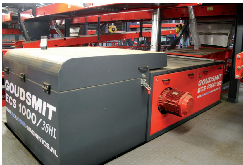
Nová generace separátorů na principu vířivých proudů odděluje jemné části (např. měděná vlákna) již od asi 0,5 mm
