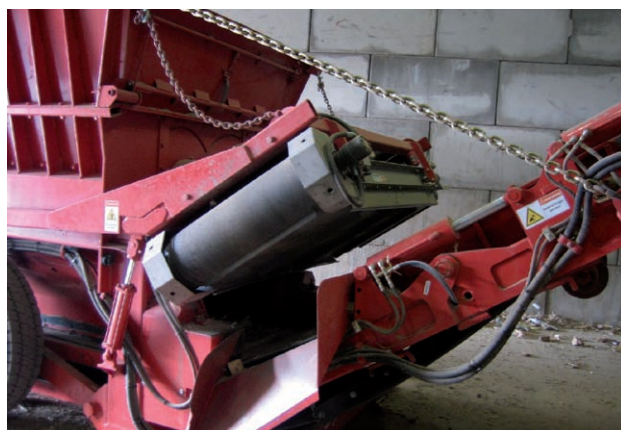
Nová generace separátorů na principu vířivých proudů odděluje jemné části (např. měděná vlákna) již od asi 0,5 mm
